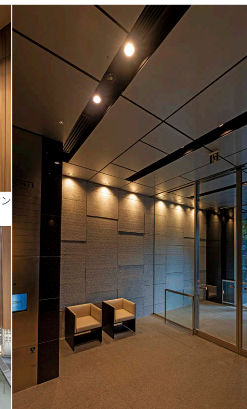
エントランス LED ユニット交換形ダウンライト③により陰影を描くことで落ち着いた空間を演出。
