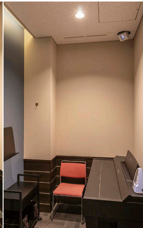
(左)第8レッスンスタジオ・(右)第6レッスンスタジオ 個人レッスンに適したコンパクトなスタジオにも、部屋中央部に照射角度を合わせてUVeeユニバーサルダウンライト①を配置し、有人モードで運用。
