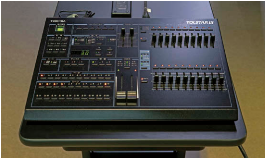
舞台袖操作卓⑦ 舞台袖にも使い勝手の良い調光操作器を備えワンマンオペレーションを可能に。
