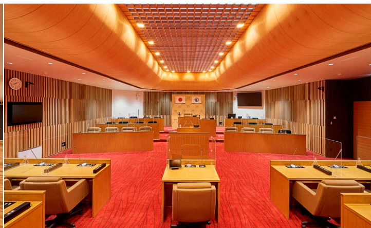
3階 本会議場 天井の曲面に陰影を描くようLEDダウンライトを配置。
