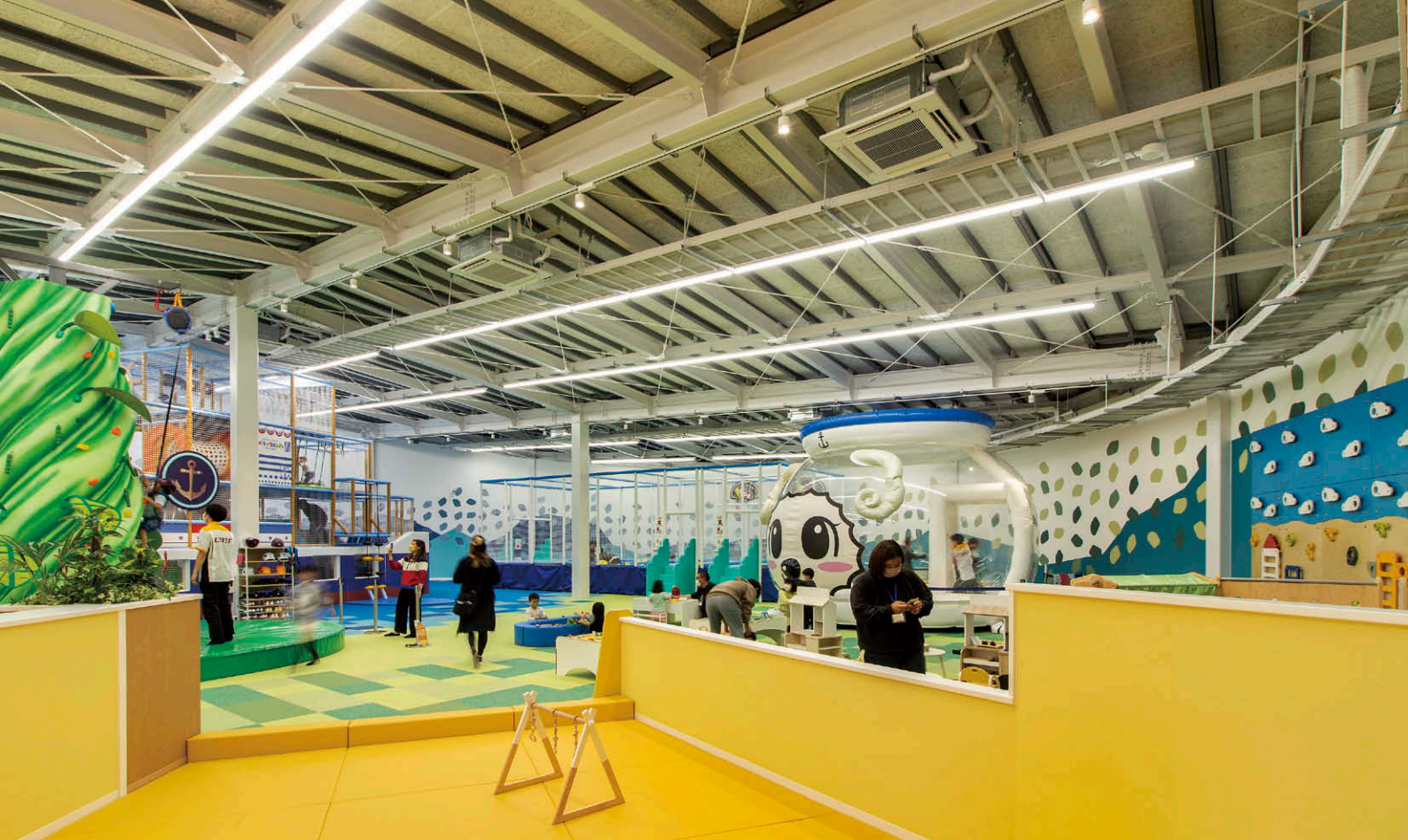
屋内遊び場の遊び場スペースの照明 曲面構造で傾斜している天井に、5000KのLEDベースライト⑥をシームレスに連結してライン状に設置。4000KのLEDスポットライト⑦も計36台採用し明るい照明環境を創出。
