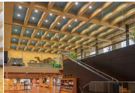
エントランスホール 特注の吊下げアダプターを使用してLEDユニット交換形ダウンライト⑥を配置。
