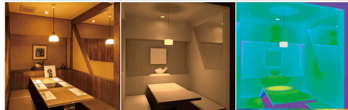
料理のイメージを損なわない従来の適正な照度を確保するため、照度CGシミュレーションによって検証し器具選定しています。
