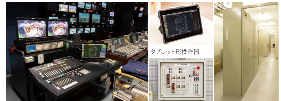
調光操作卓 マルチファンクションベルトフェーダ30本を備えたフルLEDスタジオ専用調光操作卓⑥。RDM双方向通信により照明器具を自動認識。
