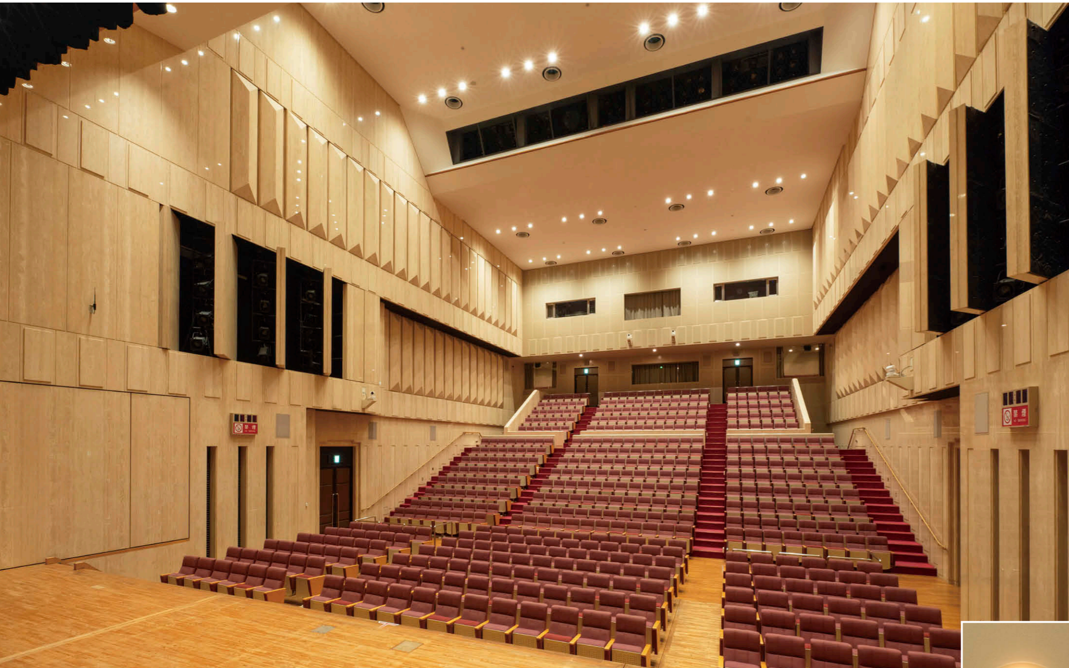
くすのきホール 客席天井に、調光にあわせて色温度が変化するLEDシアターシリーズダウンライト①②を採用し、劇場空間の特別なあかりを実現。
