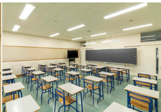
高校普通教室 直付下面開放のLEDベースライト④とLED黒板灯⑩を採用。
