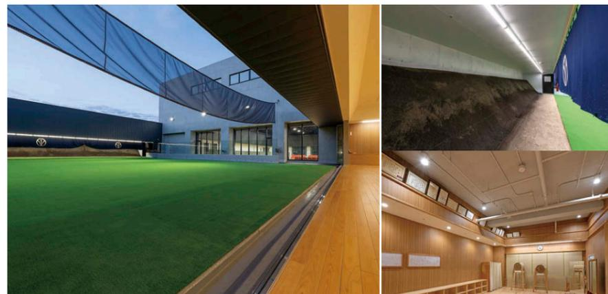
弓道場の照明 矢道は3台のLED小形投光器④により明るさを確保。的場には13台の防湿・防雨形LEDベースライト⑤を、射場控にはLEDユニット交換形ダウンライト2種⑥⑦を採用。
