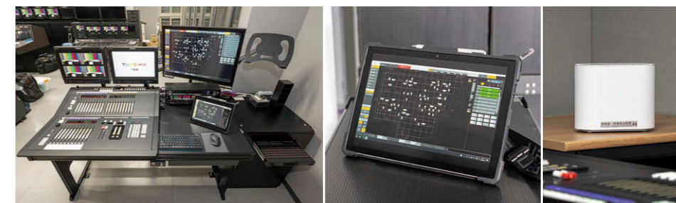
調光操作卓⑥ RDM双方向通信により照明器具を自動認識し、効率化を実現。タブレット導入で業務を効率化。UVish⑦で空間を除菌・脱臭
