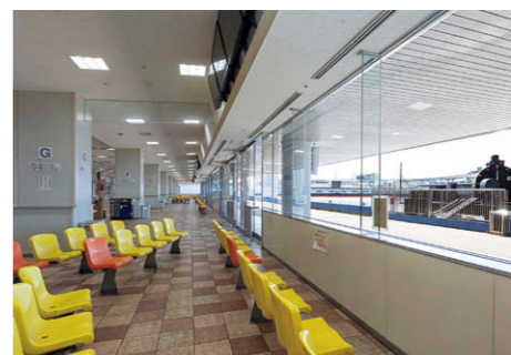
観覧席 LEDバータイプのLEDスクエア器具パツフルタイプ⑤を32台採用。
