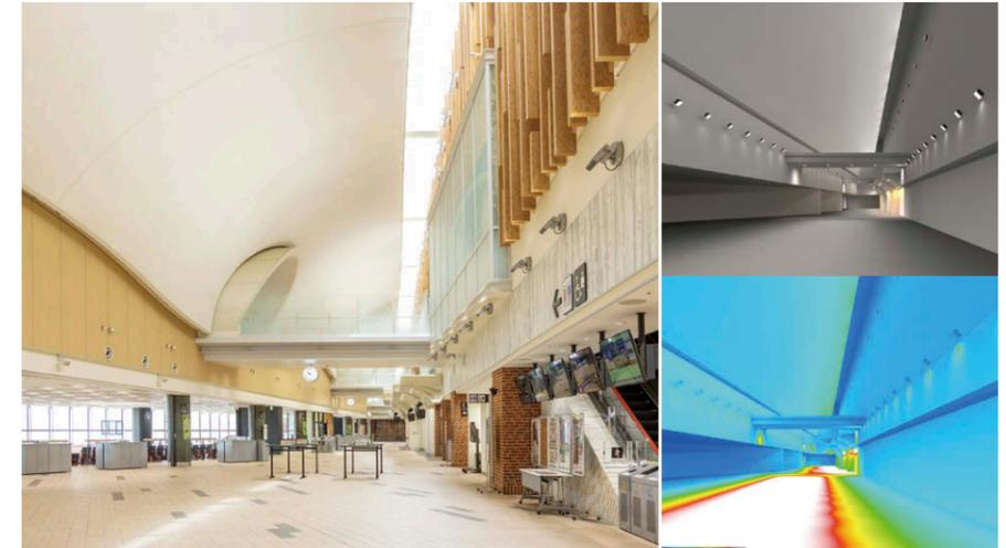
簡易CG(右)によるシミュレーション LED投光器①②③の配光イメージを簡易CGにより確認
