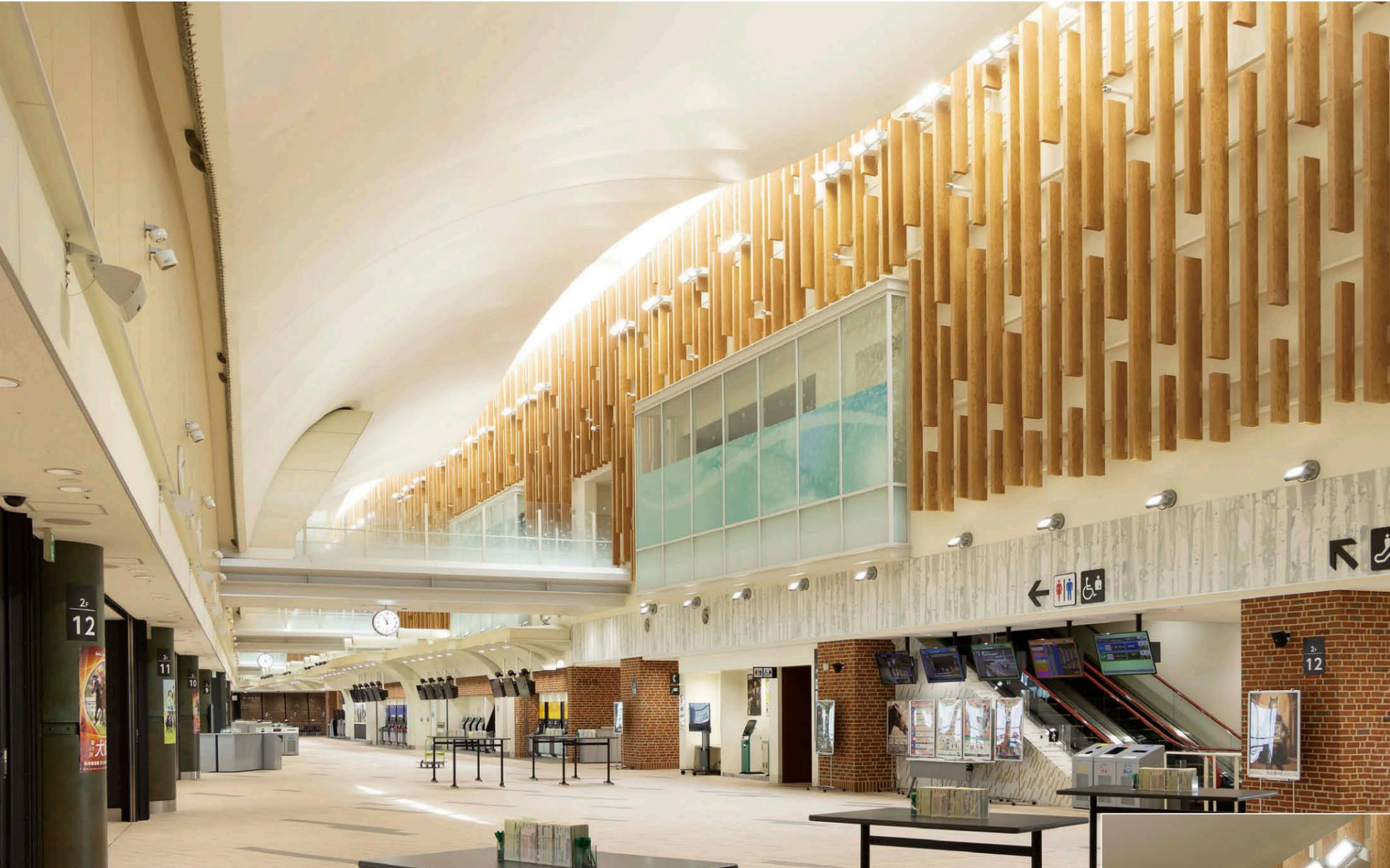
雲の広場 右手壁面中段に上向きに配置したLED投光器①が幕天井を照射し、壁面上部に下向きに配置したLED投光器②③が床面を照射
