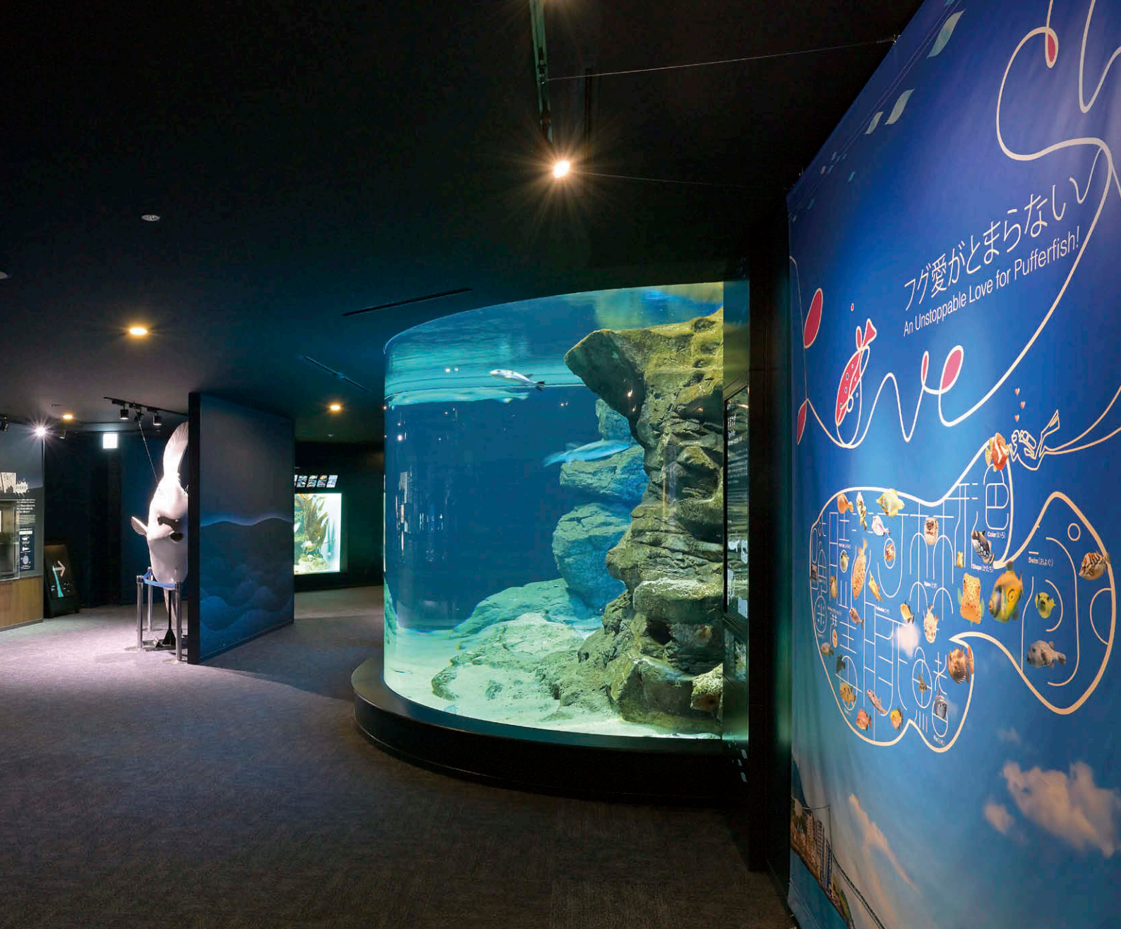
「世界のフグ」エリア 既設器具のダウンライトをLEDユニットフラット形ダウンライト②③に置き換え、マンボウの模型をライティングレール用スポットライト⑤で照射
