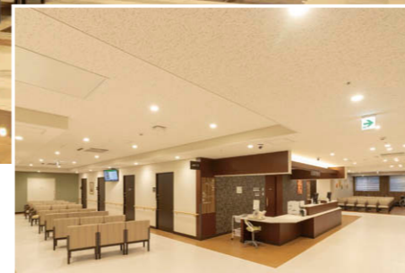
3階外来受付付近の照明 電球色の照明器具①が来院者の不安を和らげる温かみのある空間を演出
