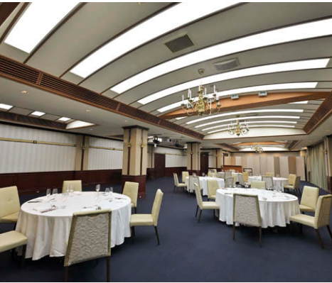
宴会場「潮騒」の照明シーン例 建築化照明には直付形の調光調色器具①144台を使用してさまざまな照明環境を創出(左/電球色パターン 右/昼白色パターン)
