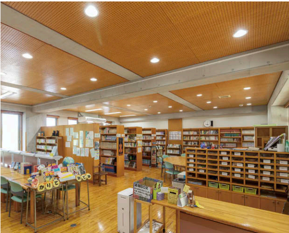
1F図書室 LEDユニット交換形ダウンライト⑤による照明
