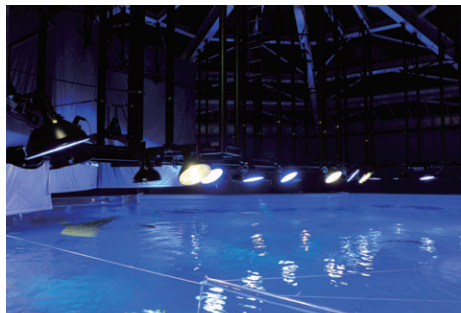
水槽上部海面上約2mの位置にHID投射器(ブルーと白色の光色)を配置
