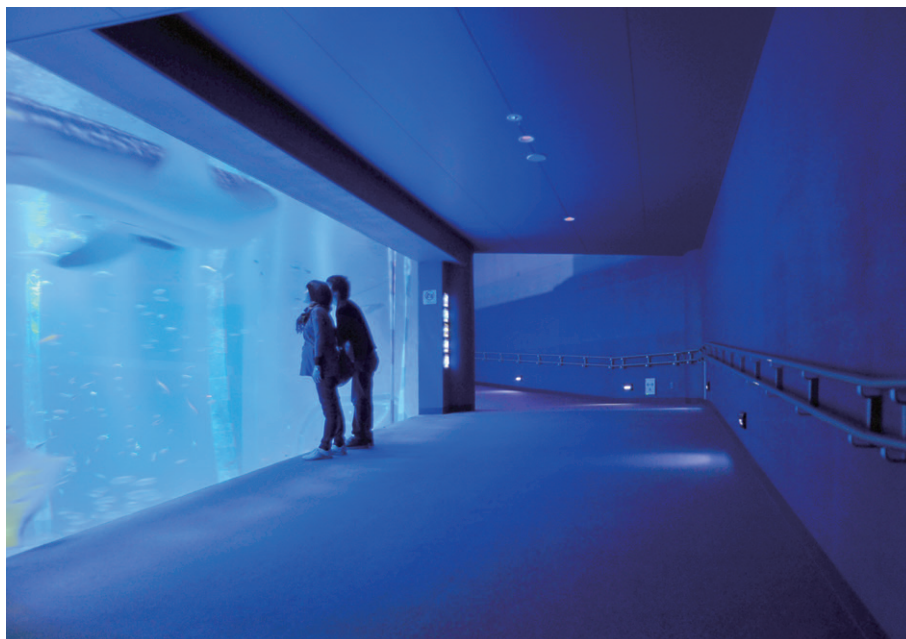
中2階の位置の視点場(観賞・観察場)から水槽内を望む。天井にはLEDダウンライト、壁面下部にはLEDフットライトを設置
