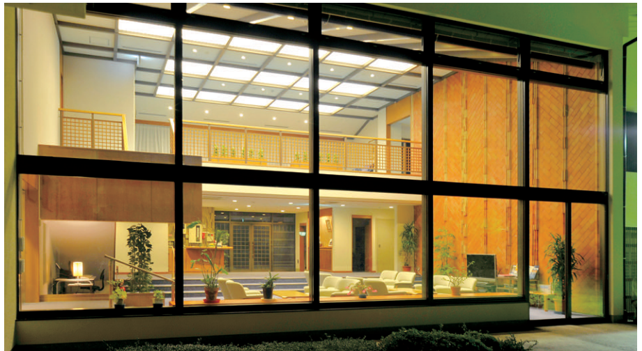
ロビー・ホールの照明 建築化照明部にHf蛍光ランプを採用し、その間にはLEDダウンライトを設置して省エネ、CO 2 低減を配慮しつつ、省メンテナンスを実現
