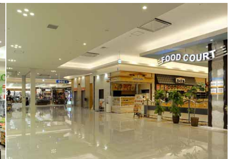
2階フードコート前の広いスペースにはLEDライトエンジンダウンライトを4台1組で配置
