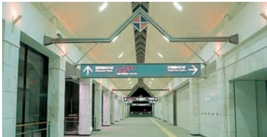
自由通路 屋根中央の自然光と埋込ダウンライトの明かりの誘導 Free passageway
