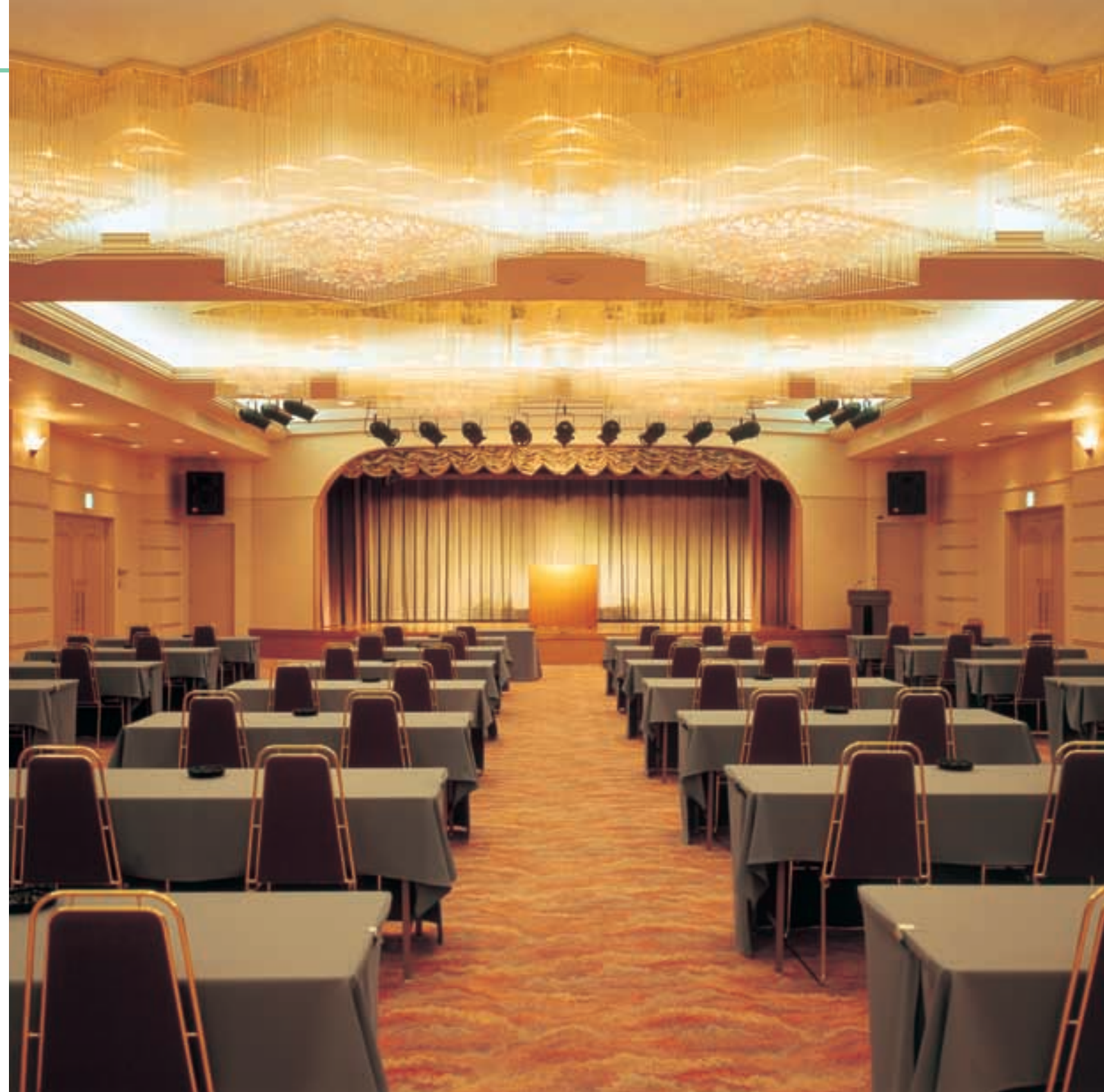
6階 コンベンションホール“羽衣” Convention hall “Hagoromo” 12000×2000、H2000の特大シャンデリアを4台設置。クリアーガラスパイプとストラスピースから広がるフィラメントはミニクリプトンランプ40W×104灯の輝き。
