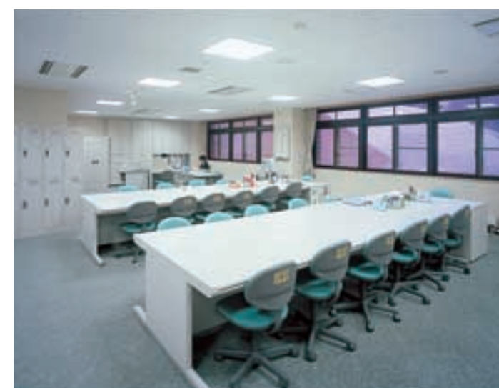
ホームヘルプステーション Home helpers' station 36Wユーライン3灯用スクエア器具を均等配置し、すっきりした明るい照明空間を形成している
