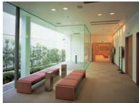
1階ロビー 1st Floor Lobby メタルハライドランプダウンライトをベース照明とし、壁面展示用のハロゲンランプスポットライトを設置している
