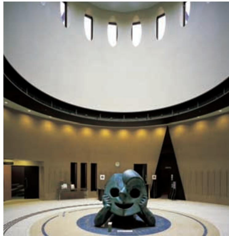
エントランスホール The Entrance Hall 石段を上がり洞窟に入るイメージで設計され、床の青いタイルは緑地に湧き上がる水をイメージ。天井ドームのトップライトによる自然採光と、ハロゲンランプ埋込器具による人工光の補助光で広がり感をつくり出している
