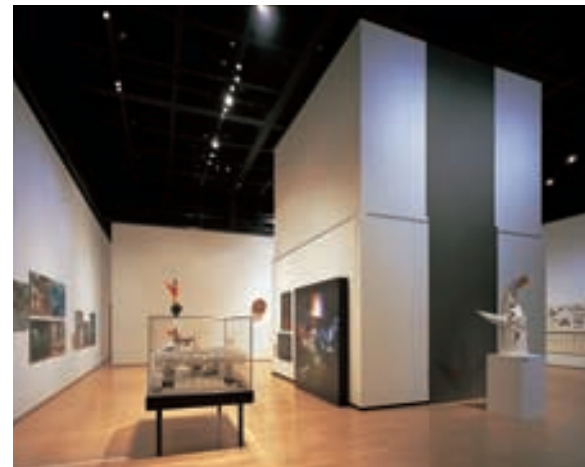
企画展示室(2) Visiting Exhibition Hall (2) ベース照明にはコンパクト形蛍光灯ランプダウンライト(UVカットフィルター付)を設置し、局部照明にはライティンググレーとハロゲンランプ用スポットライト器具を使用し、展示品を自然に再現
