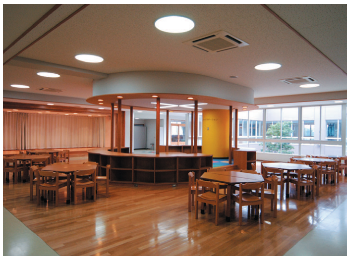
メディアステーション：仕切りをなくし、図書室・コンピュータ室を一体で利用できるようにしたメディアステーション。円形の開架コーナー周囲に36Wコンパクト形蛍光ランプ3灯用埋込カバー器具を配している
