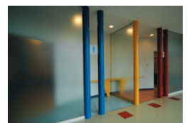
トイレ：カラーポールで男女別に色分けし、くもりガラスで目かくしをした明るいトイレ前には16Wコンパクト形蛍光ランプ電球色のダウンライトを4台設置(人感センサー付き)
