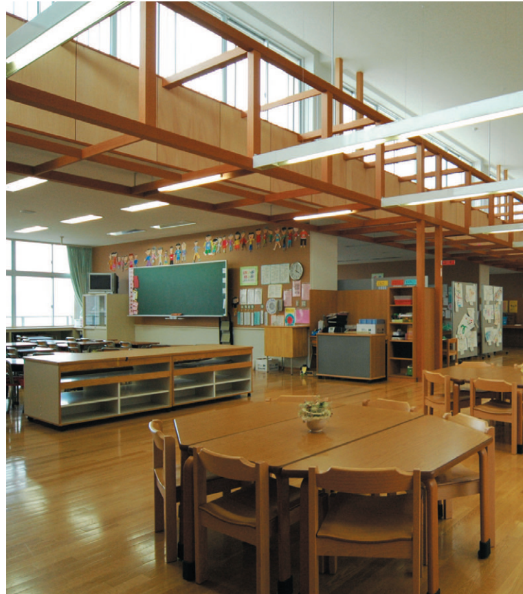
オープンスペースから教室を見る:特注3連結器具をワイヤー吊りとしたため、圧迫感がなく明るい空間となっている
